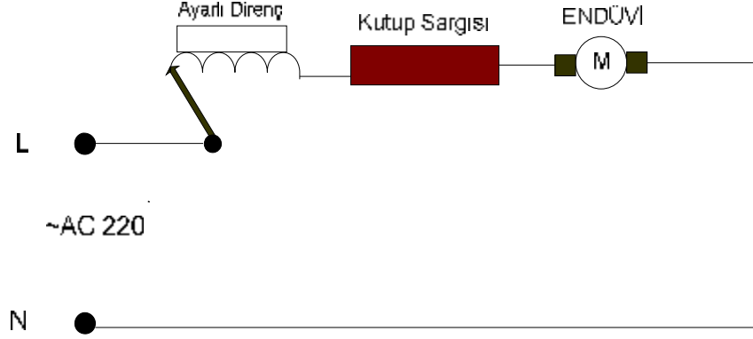
Şekil 2.9: Üniversal seri motor prensip şeması-1
