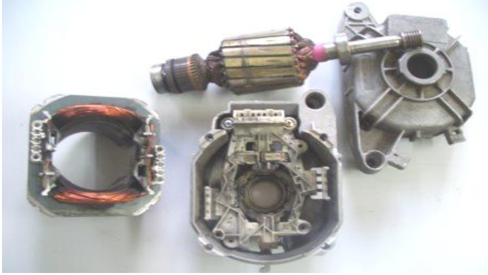
Resim 1: Üniversal motor ve parçaları
