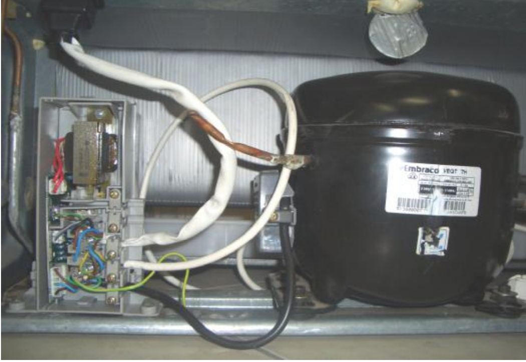
Resim 2.3: Buzdolabı kompresörü ve sürücü devresi
