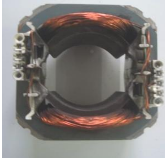
Şekil 1.7: Üniversal motorların kutup yapısı
