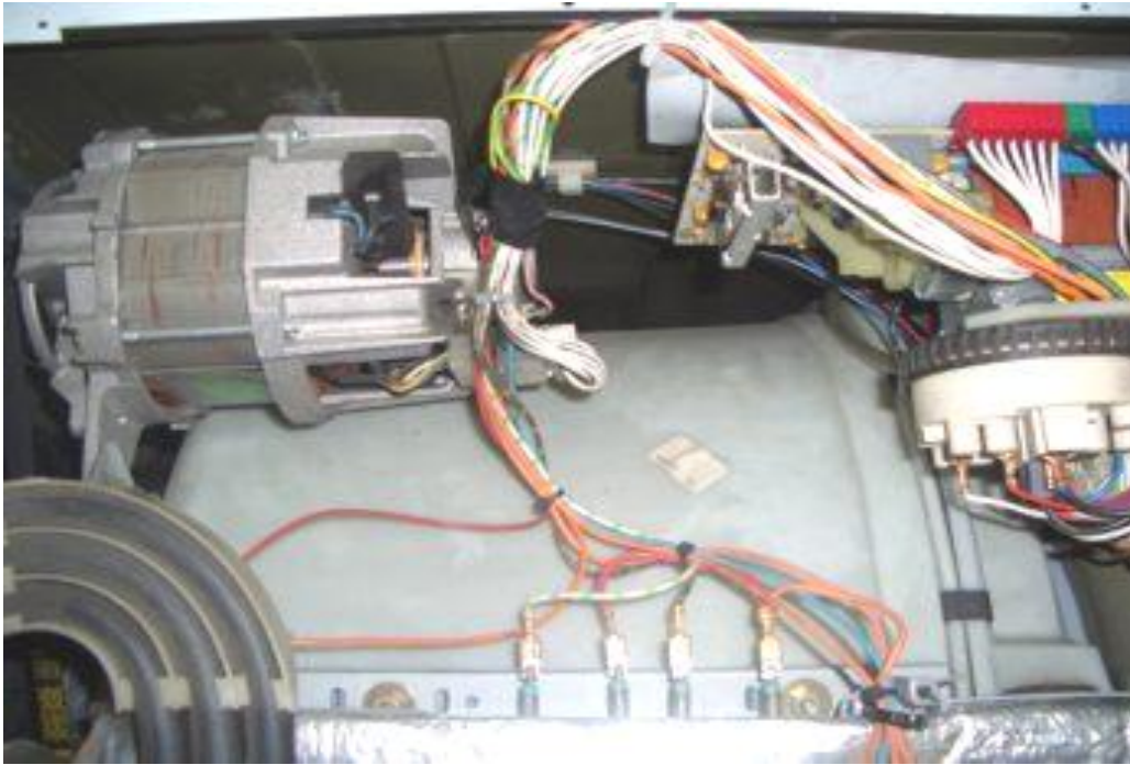
Resim 2.2: Çamaşır makinelerinde kullanılan A.C seri motor
