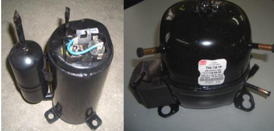
Resim.1.3 Klima ve buzdolaplarında kullanılan kompresör motoru
