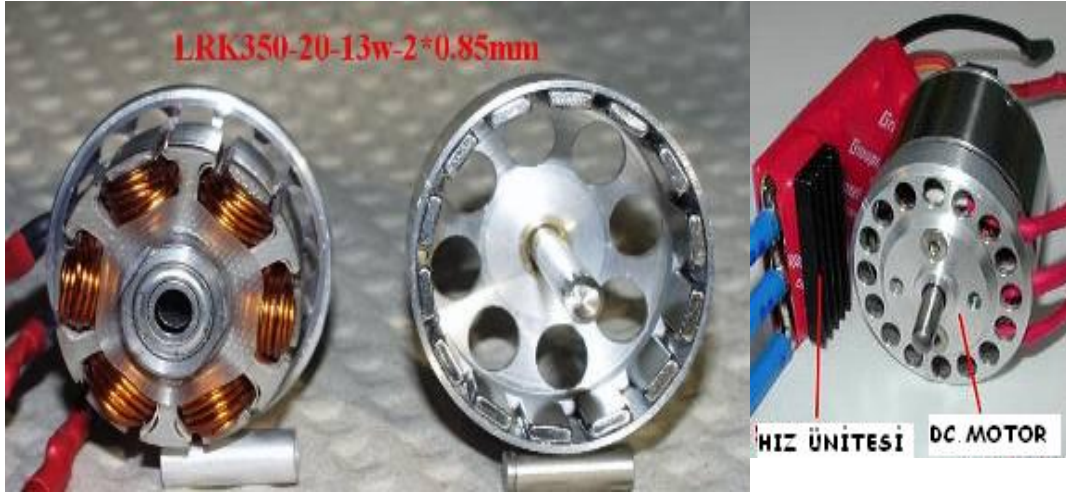
Resim 1.1: Fırçasız (brushless) D.C. motor ve hız modülü
